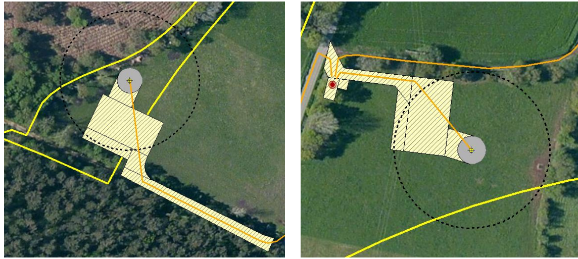
Figure 147 : Illustration du retrait des plateformes et chemin d'accès d'E2 (droite) et d'E3 (gauche) vis-à-vis des haies.
